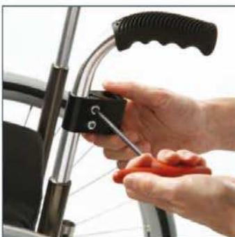
Rückenbespannung entfernen und Halteblöcke montieren
