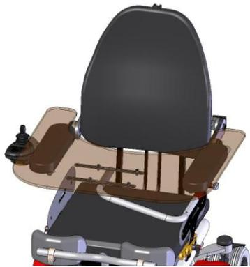
Der abschwenkbare Tisch kann zur Seite abgeschwenkt werden, wenn er nicht gebraucht wird.
