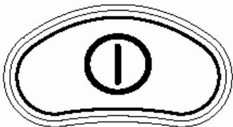
Mit der Ein-/ Aus-Taste kann der Rollstuhl ein- und ausgeschaltet werden. Benutzen Sie diese Taste nicht zum stoppen des Rollstuhls, es sei den es ist ein Notfall.
