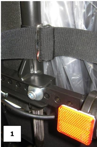
Der Brustgurt wird um die Rückenholmen (Abbildung 1) positioniert. Die Höhe des Brustgurtes kann angepasst werden.
