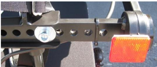
Lösen Sie die beiden Schrauben, nun können Sie die Armlehnen in der Breite verschieben.
