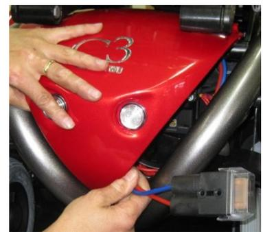
Die Hauptsicherung ist hinten unter der Abdeckung. Öffnen Sie die Abdeckung um an die Sicherung zu gelangen.
