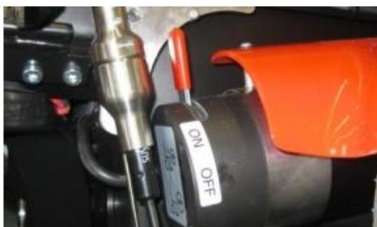
Um die Motorbremsen zu entriegeln, damit man den Rollstuhl schieben kann, schalten Sie das Bedienteil aus, ziehen Sie denn Knopf (A) raus und drücken Sie den Hebel (B) nach unten.
