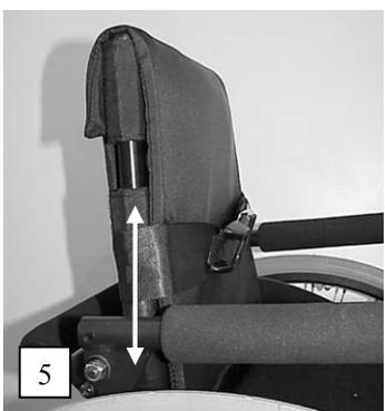
Die Armlehnen sind individuell anpassbar und können durch Verschiebung am Rückenrohr stufenlos von minimal 14 cm ab Sitzträger bis maximal 22 cm ab Sitzträger verstellt werden. (siehe Abbildung 5).
