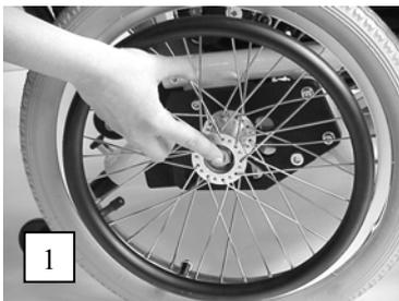
Der LEVO *KID* & *JUNIOR* ist standardmässig mit Luftbereifung ausgerüstet. Der Raddurchmesser ist abhängig von der Sitzhöhe des Rollstuhles. Dank der Steckachsen können die Hinterräder leicht abgenommen und wieder angesteckt werden (siehe Abbildung 1).
