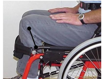
Kniehalter-Befestigungs-schraube hinter Drehpunkt von Knie
