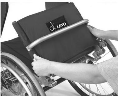
Die beiden Klapphebel können auch durch eine Schnur verbunden werden. In diesem Falle ziehen Sie die Schnur nach hinten/oben und drücken gleichzeitig den Rücken nach vorne.
